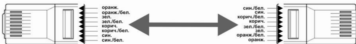
Рис. 4. Схема подключения вилки RJ45
