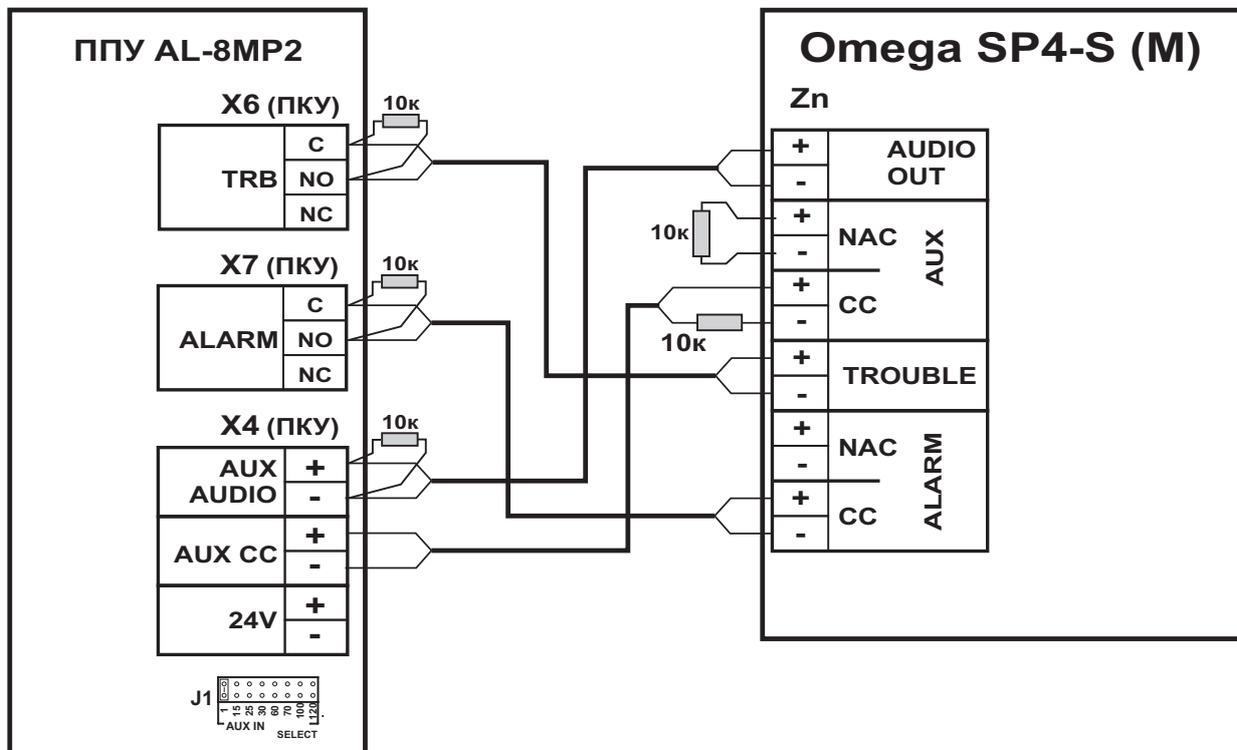
**Примечание: Переключатель J1 должен быть установлен в положение 1 В.**
