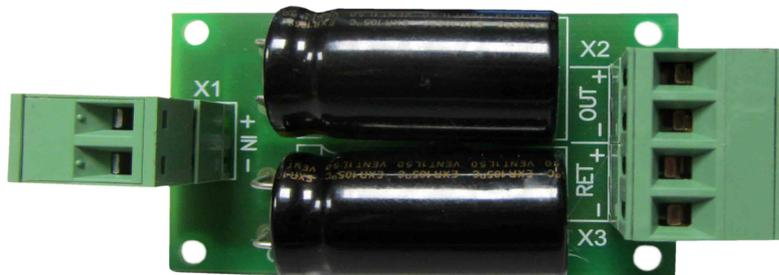
Предназначен для подключения радиальной линии к кольцевой линии связи с речевыми оповещателями.
